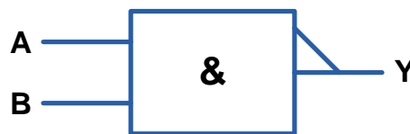
Σχ. 5/85 Νέο σύμβολο λογικής πύλης NAND δύο εισόδων
