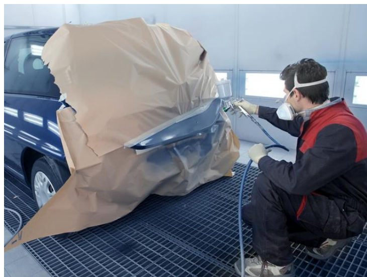
Σχ. 2/15 Χρήση πιεσμένου αέρα για τη βαφή αυτοκινήτων
