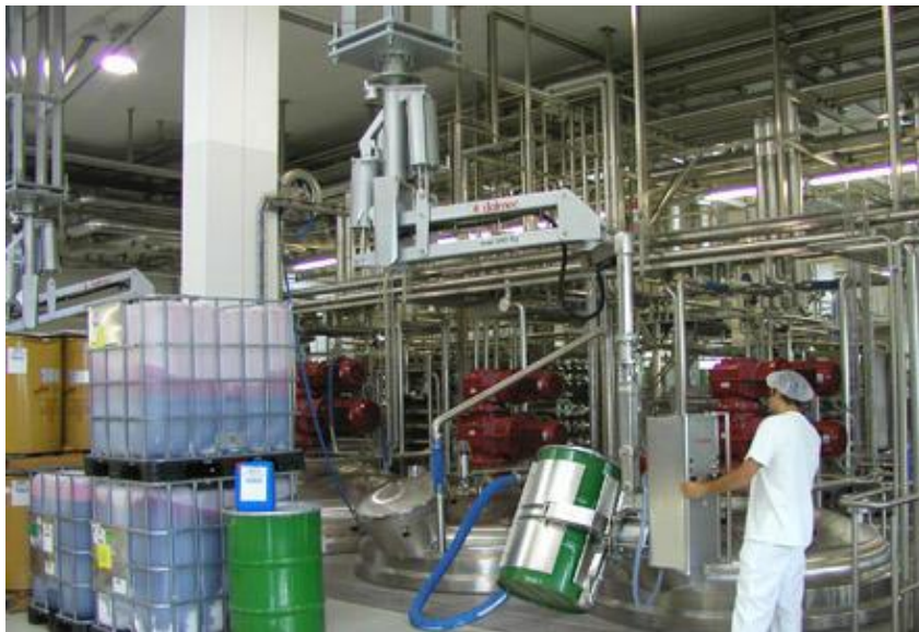
Σχ. 2/16 Τα πνευματικά συστήματα είναι ασφαλή σε χώρους όπου υπάρχουν χημικά ή/και εύφλεκτα υγρά
