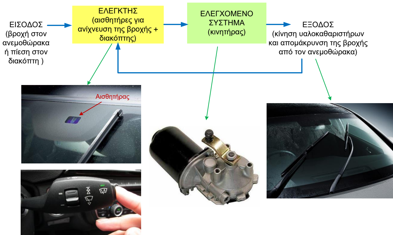
Σχ. 3/9 Υαλοκαθαριστήρες αυτοκινήτου με χειροκίνητο και αυτόματο έλεγχο.
