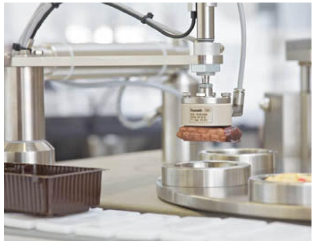
Σχ.2/12 Πνευματικά συστήματα χρησιμοποιούνται για τη συσκευασία τροφίμων
