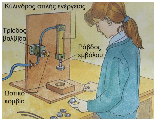
Σχ. 2/41 Συσκευή σφραγίσματος η οποία ελέγχεται από πνευματικό κύκλωμα
