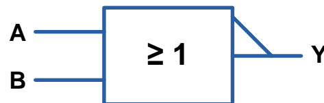
Σχ. 5/90 Νέο σύμβολο λογικής πύλης NOR δύο εισόδων
