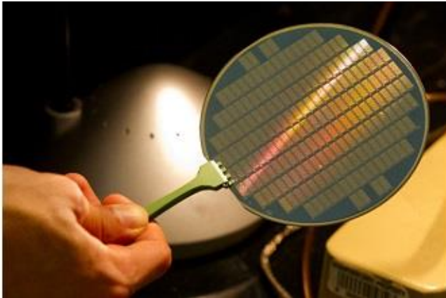
Σχ. 5/95 Δίσκος πυριτίου με ολοκληρωμένα κυκλώματα
