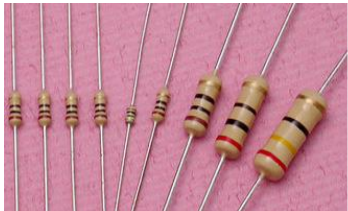
Σχ.5/6 Αντιστάτες σταθερής τιμής μεμβράνης άνθρακα
