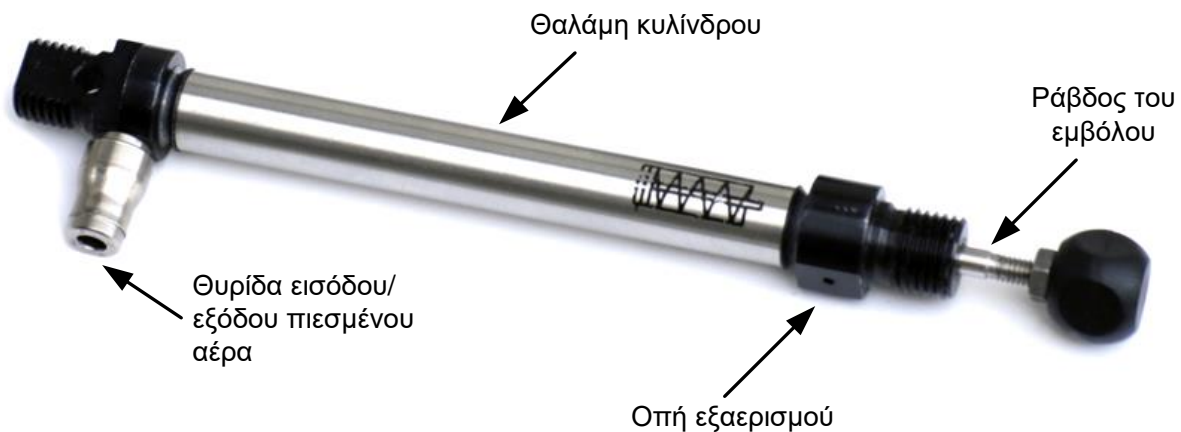
Σχ. 2/26 Κύλινδρος απλής ενέργειας με ελατήριο επαναφοράς
