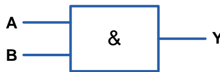
Σχ. 5/72 Νέο σύμβολο λογικής πύλης AND δύο εισόδων
