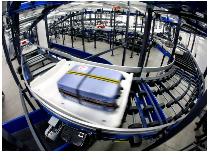
Σχ. 3/1 Αυτόματο σύστημα μεταφοράς και διανομής αποσκευών σε ένα αεροδρόμιο
