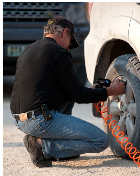
Σχ. 2/5 Γέμισμα ελαστικού με πιεσμένο αέρα
