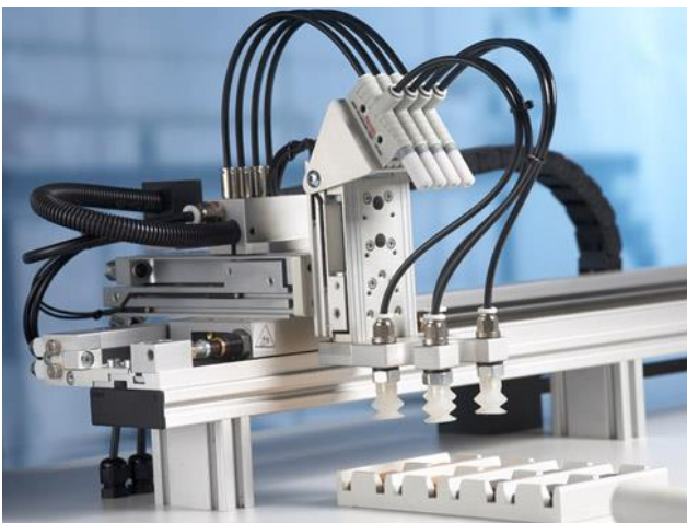
Σχ.2/11 Πνευματικά συστήματα χρησιμοποιούνται για τη συσκευασία φαρμάκων
