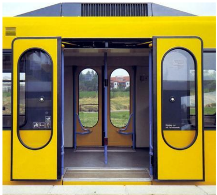
Σχ.2/8 Οι πόρτες σε αμαξοστοιχία ανοιγοκλείνουν με χρήση πιεσμένου αέρα
