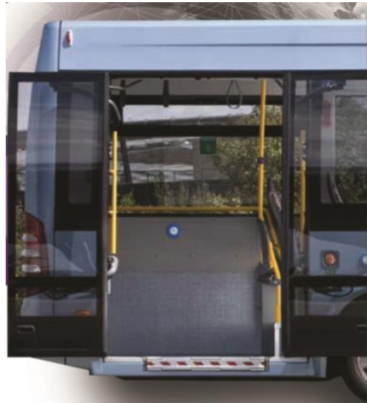
Σχ.2/45 Θύρα λεωφορείου που ελέγχεται από πνευματικό σύστημα
